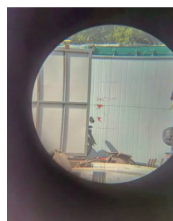
图8:利用经纬仪复核桩身垂直度
