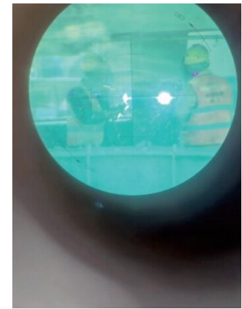
图10-11:桩头两端垂直度偏差值
